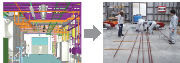
BIMの3Dデータを基にした配管の工場加工
