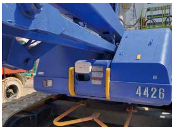
建設重機へのIoTデバイス装着状況
