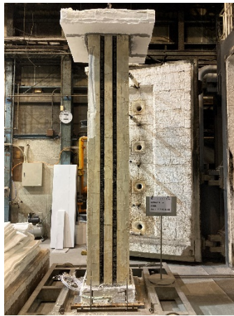
耐火試験終了後の「燃エンウッド（3時間耐火）」
