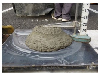
普通コンクリート
