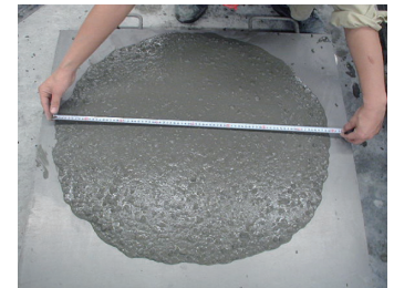
Photo 15 高流動コンクリートのスランプ Slump of the high flow concrete
