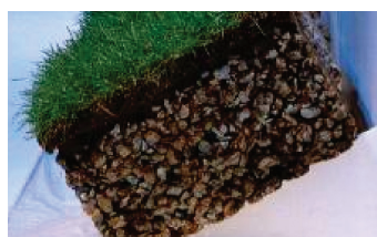
Photo 10 初めて植栽に成功した緑化コンクリート試験体 An Green Concrete specimen succeeded growing grass for the first time
