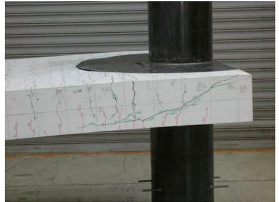
Photo 1 最終破壊状況
