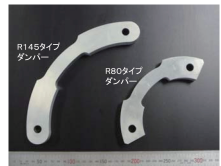
Photo 4 ダンパーの種類 (R145タイプ, R80タイプ) R145 type and R80 type damper
