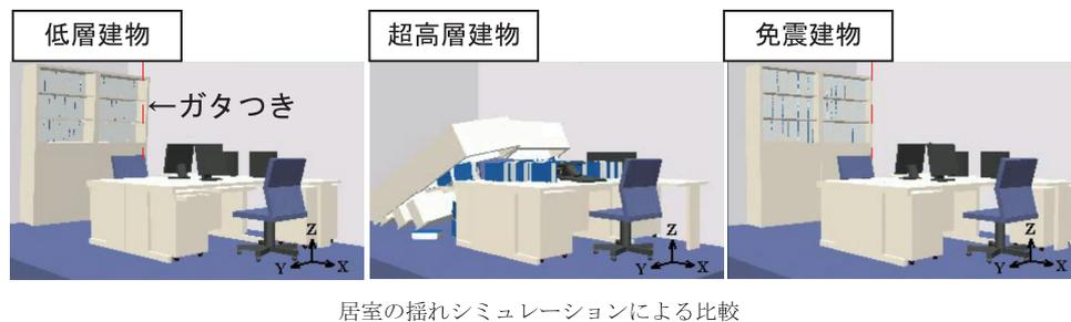
Fig. 2 長周期地震動を受ける低層・超高層・免震建物の室内状況例
