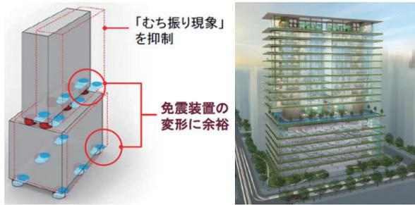
Fig. 12 多段免震（ダブル免震）
