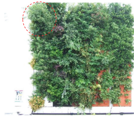
Photo 3 1年後の壁面緑化試験体 (2007年6月) Wall greening test body after one year
