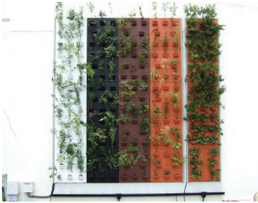
Photo 2 植栽直後の壁面緑化試験体 (2006年8月) Wall greening test body after planting
