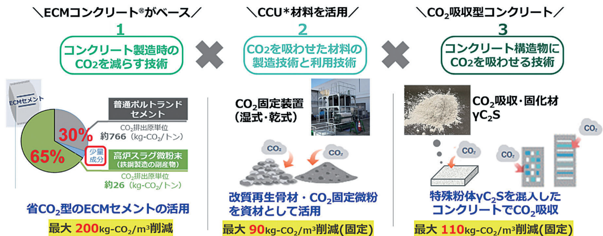
Fig. 10 カーボンネガティブコンクリートを構成する技術の概要 Outline of technology for constructing carbon-negative concrete
