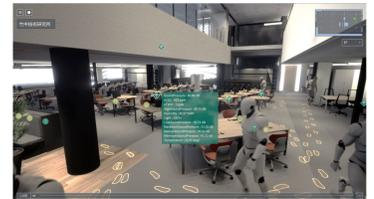
仮想空間上で、建物の設計データと人の行動モデルを用いて人流を計算し、建物の使われ方をシミュレーションします。シミュレーションに用いる行動モデルを切り替えることで多角的な空間の使われ方を検証可能です。
